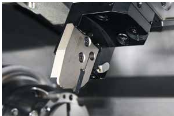
Jet de liquide de refroidissement x 2 : La technologie « ACS » brevetée pour le système de tronçonnage/usinage de gorges SA d'ARNO impressionne le prolongement considérable de la durée de vie.
